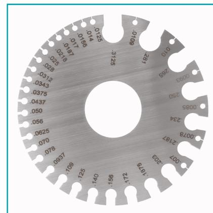
**\*Nombre:** (2 UND) Medidor de calibre y de espesor de láminas.
