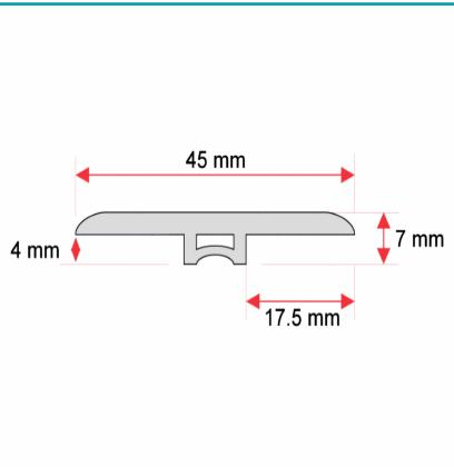
**\*Nombre:** Transición tipo T para piso SPC Silver Stone 2400 mm**¿Dónde usarlo?:** 2400 mm**Características:** Fácil de cortar e instalar.**Código de Barras:** 7454891673310**Código de producto:** DE035-B**Color:** Silver Stone**Marca:** CARBONE**Materiales:** Compuesto plástico de alta calidad con acabado piedra.**Procedencia:** Importado**Resiste:** anti termitas, alto tráfico.**Se vende por:** Unidad**Usos:** Decoración**INFORMACIÓN ADICIONAL**
