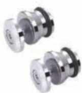
El sistema incluye dos cilindros de seguridad que se instalan en la puerta de tal modo que el riel queda entre los rodamientos y estos cilindros. Así se consigue que la puerta nunca pueda salirse de su desplazamiento horizontal evitando que la puerta se pueda levantar y descarrilar. Estos cilindros son excéntricos para poder ajustarlos a su adecuada posición.
