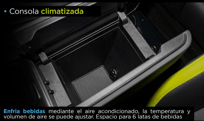
**Enfría bebidas** mediante el aire acondicionado, la temperatura y volumen de aire se puede ajustar. Espacio para 6 latas de bebidas
