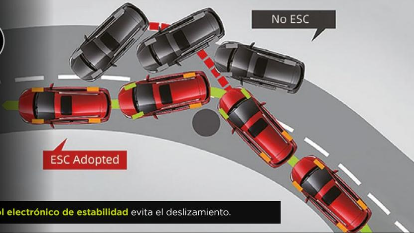
El **control electrónico de estabilidad** evita el deslizamiento.
