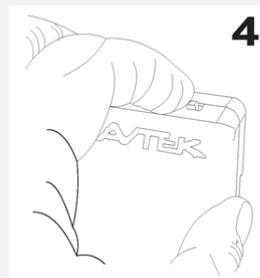
4.-Coloque nuevamente la tapa de las borneras, reconecte la energía eléctrica y encienda el interruptor del protector utilizando el interruptor ubicado en la parte superior.
