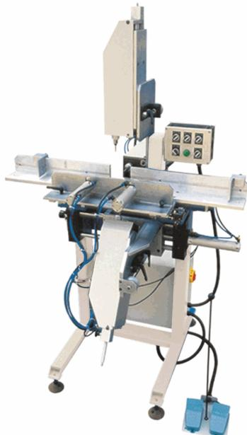
Ranuradora de Vierteaguas para Ventanas PVC | Auto Water Slot Milling Machine 3 Ejes – Carpintería PVC
