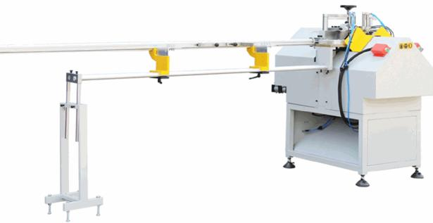
**Maquina Cortadora de Junquillos 45° para Perfiles Ventanas PVC.
