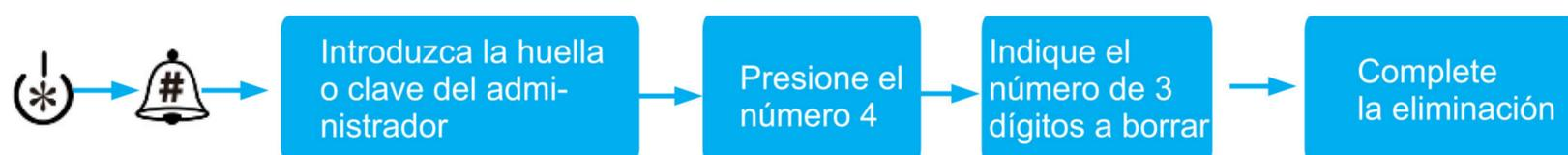
En estado de reposo, presione \* para activar el panel, posteriormente presione # e indique la huella o contraseña del administrador para entrar al menú de configuración. Presione el número 4 y coloque el número identificador de 3 dígitos del usuario a borrar y confirme con la tecla #.
