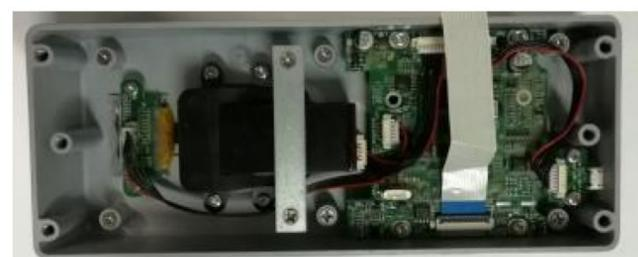
Como se muestra en la siguiente figura, remueva el cable y páselo por el agujero del bracket.
