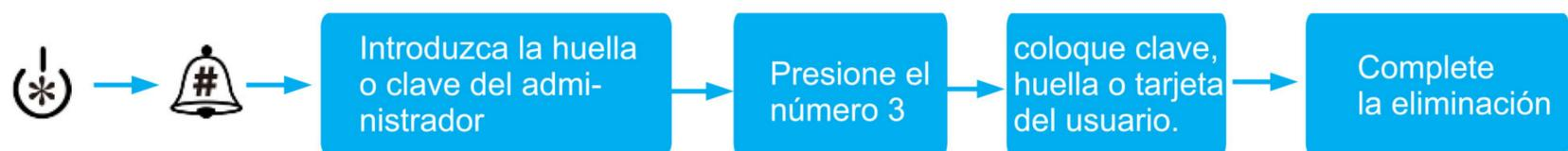
En estado de reposo, presione \* para activar el panel, posteriormente presione # e indique la huella o contraseña del administrador para entrar al menú de configuración. Presione el número 3 y coloque la huella, tarjeta de proximidad o contraseña de usuario que desea borrar.
