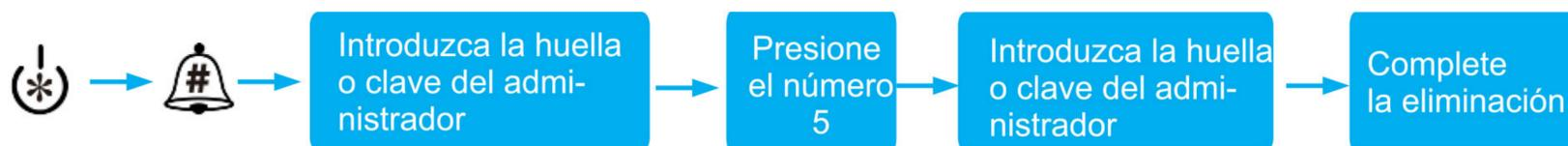
En estado de reposo, presione \* para activar el panel, posteriormente presione # e indique la huella o contraseña del administrador para entrar al menú de configuración. Presione el número 5 y confirme con la huella, clave o tarjeta del administrador.
