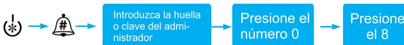
En estado de reposo, presione \* para activar el panel, posteriormente presione # e indique la huella o contraseña del administrador para entrar al menú de configuración. Presione el número 0 y luego el 8. Presione # para los siguientes o \* para los anteriores. Para salir, presione cualquier otra tecla.
