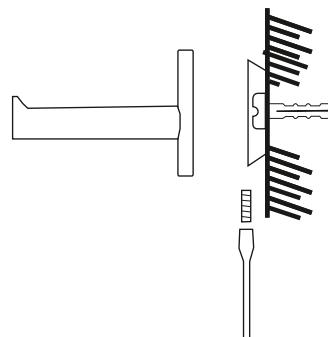
4.- Coloque el accesorio sobre el ancla y con la ayuda de un desarmador plano apriete el opresor para fijar el accesorio.
