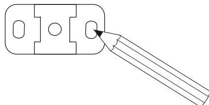
1.- Coloque el ancla con la cara lisa contra el muro (a la altura deseada) y marque los barrenos en el muro.
