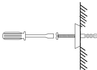
3.- Introduzca los taquetes en los orificios del muro y coloque el ancla haciendo coincidir los barrenos con los taquetes y atornille la piñas.
