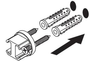
4. Coloque el accesorio sobre el ancla (B), por la parte de abajo rosque el opresor (D) y apriete hasta fijar firmemente.
