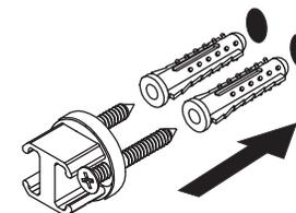
4. Coloque el accesorio en su lugar sobre el ancla (G), por la parte de abajo rosque el opresor (D) y apriete hasta fijar firmemente. Posteriormente coloque el dispensador de jabón sobre el soporte.
