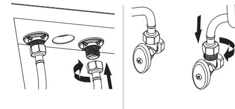
3. Rosque un extremo de las mangueras flexibles (no incluidas) en las entradas correspondientes del cuerpo (K) y el otro extremo a las llaves angulares (llaves de paso) de la toma de agua.
