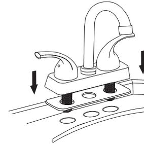
1. Por debajo de la mezcladora coloque la tapa de la cubierta (L) y posteriormente inserte la mezcladora en los orificios correspondientes del lavabo.
