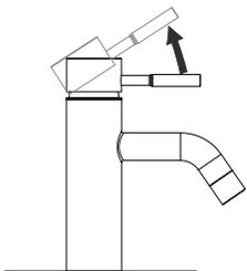
Para abrir el flujo de agua, jale la palanca hacia arriba. Para cerrar el flujo empuje la palanca hacia abajo.
