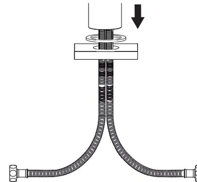
Coloque el empaque del cuerpo (D) por la parte inferior del monomando e introduzca los birlos (G) y mangueras (I) del monomando a través del barreno central del mueble, asegúrese que el empaque del cuerpo quede bien colocado y firme contra el mueble.
