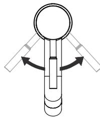
Para regular la temperatura del agua, gire la palanca hacia la izquierda (agua caliente) y hacia la derecha (agua fría).
