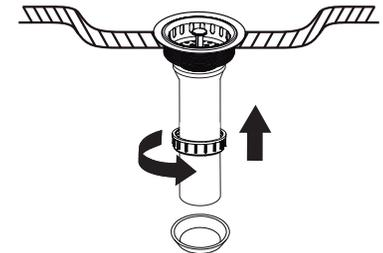
4.- Conecte el extremo roscado de los tubos en "L" (C) a las contra canastas, rosque las tuercas de acople (A) en sentido de las manecillas del reloj y asegúrese que quede completamente fijo.
