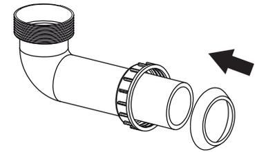
2.- Conecte los tubos en "L" (C) a la conexión "T" (D) y rosque las tuercas de acople (A) en sentido de las manecillas del reloj. Asegúrese que todas las conexiones queden bien fijadas.
