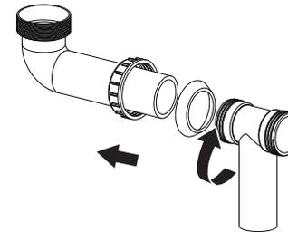
3.- Coloque la tuerca de acople (A) seguido del empaque (B) en el tubo de descarga de las contra canastas (no incluidas).
