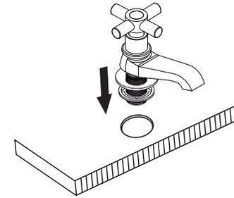
1.- Inserte la llave individual junto con el chapetón (7) y el empaque (8) en el orificio correspondiente del lavabo.
