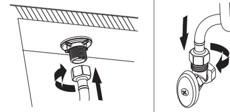
3.- Rosque un extremo de la manguera flexible (no incluida) en las entrada correspondiente del cuerpo (6) y el otro extremo a la llave angular (llave de paso) de la red hidráulica.
