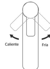
2.- Para regular la temperatura del agua, gire el maneral (1) hacia la izquierda para agua caliente y hacia la derecha para agua fría.
