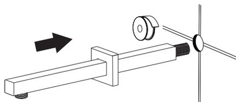
1.- Coloque cinta selladora en un extremo del brazo (no incluidos) y róselo firmemente a la salida del agua, si es necesario utilice una llave inglesa. Use una franela entre la llave y el brazo para no maltratar el producto, posteriormente deslice el chapetón (no incluido) hacia el muro.
