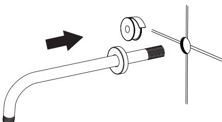
1.- Coloque cinta selladora en un extremo del brazo (no incluidos) y róskuelo firmemente a la salida del agua, si es necesario utilice una llave inglesa. Use una franelas entre la llave y el brazo para no maltratar el producto, posteriormente deslice el chapetón (no incluido) hacia el muro.
