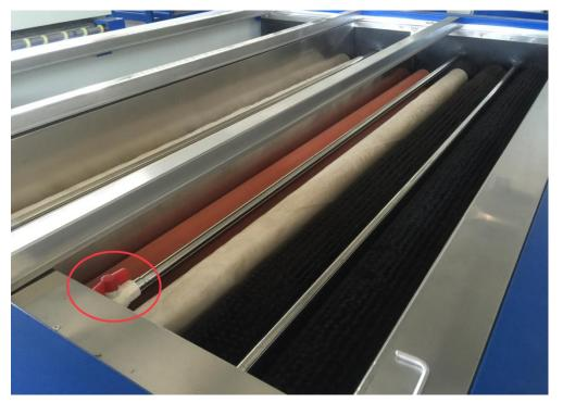
7. 吸水海绵辊严禁与油接触。
