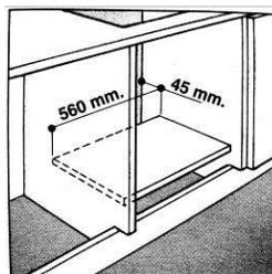
Cuando instale una placa en un horno empotrado sin ventilación forzada, asegúrese de tener entradas y salidas de aire para ventilar el interior del gabinete adecuadamente.
