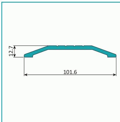
**\*Nombre:** Umbral de 4"**¿Dónde usarlo?:** Trabajos Arquitectonicos**Acabado:** Natural**Código de producto:** U118 - MILL**Color:** Gris**Espesor:** 3.8mm**Longitud:** 5.85 mts.**Marca:** CARBONE**Peso (Kg):** 1.17 Kg**Procedencia:** Importado**Se vende por:** Unidad**Tipo:** Puertas y Fijos Sistema Tradicional**Usos:** Construcción**INFORMACIÓN ADICIONAL**
