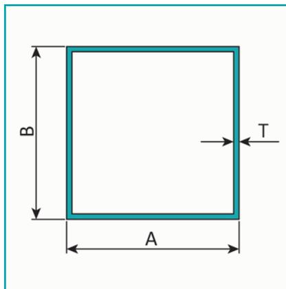
**\*Nombre:** Tubo Cuadrado 3"x3" Espesor 1.8 mm. Largo 5.85 mts. Acabado Anodizado Silver 15 Micron.
