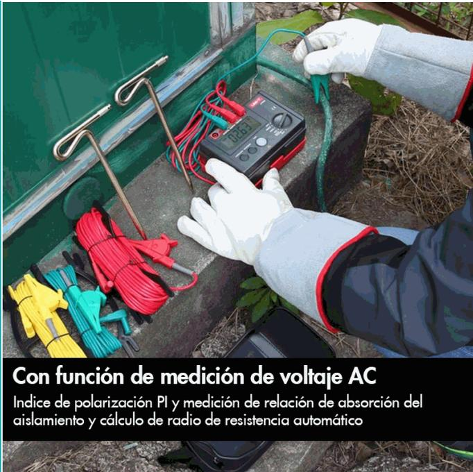
Instrumento de prueba ideal para medir la resistencia de aislamiento de transformadores, generadores, motores de alta tensión, condensadores de potencia, cables de potencia, pararrayos, etc.
