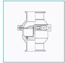
\*Nombre: Válvulas Check sanitarias tipo clamp 3A (antiretorno), pulido interno Ra ≤ 0.8 μm
