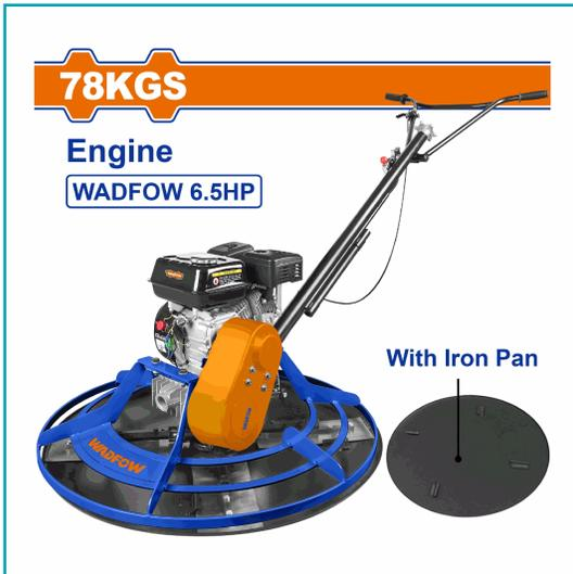
Máquina Allanadora De Gasolina. Motor De Gasolina. Potencia Del Motor: 4.8 Kw (6.5 Hp). Peso: 78 Kg. Diámetro Del Rotor: 91 Cm (36"). Número De Aspas: Cuatro. Aspa De Acabado: 35X15 Cm (14"X6"). Incluye Aspas. Con Recipiente De Hierro.
